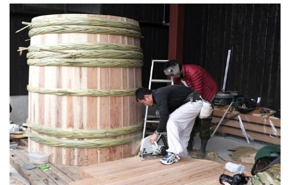
左：台鉋で押し切りをして、桶の丸みを作る。右上：吉野の弊社工場に材料を確認にいられた時の様子。右下：桶の底板を切断中。
