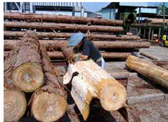
皮むきに使う道具はたった2つ、左下のカマと左上のヘラです。カマを使い1m間隔で縦に区切りをつけ、ヘラで皮をむきます。軽トラ一杯分の桧皮を取るのに約100本の原木が必要です。
