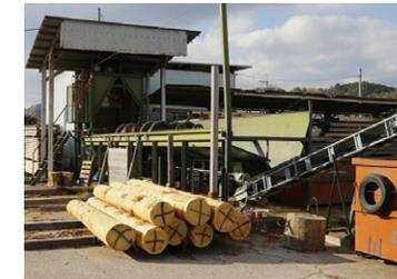
皮むき機の全体像。皮むきはできるだけ製材をする直前に行います。皮むきた原木を放置しておく、小石などが付く可能性があり、製材のノコギリを傷めてしまうからです。
