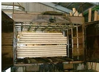
弊社で使用している低温除湿乾燥機のひとつ。これは4mまでの柱や土台などの角類専用。1mから8mの材まで乾燥可能です。
